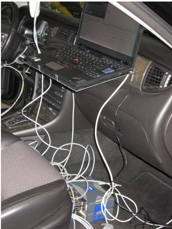
QuantumX na pokładzie pojazdu testowego.
