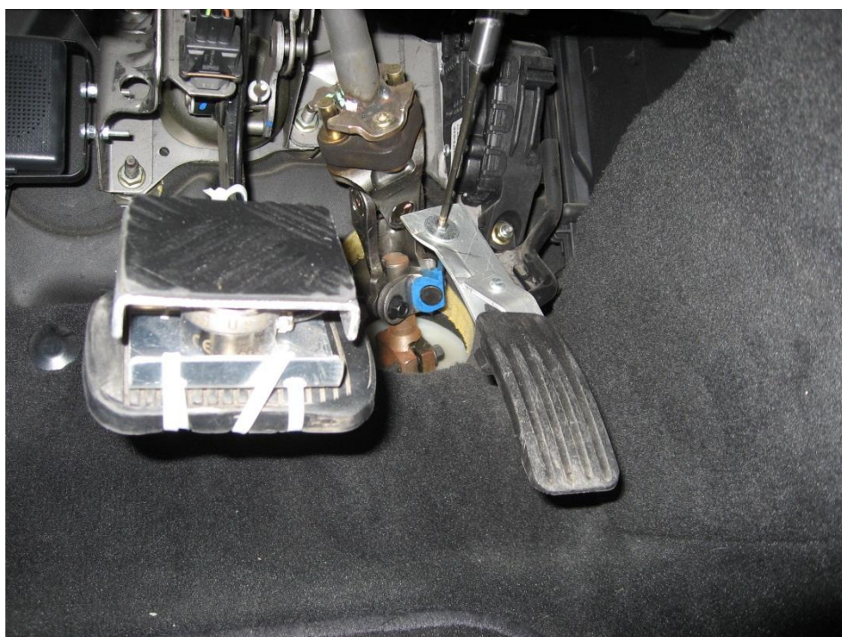
Pedał hamulca z przetwornikiem siły U93 HBM'u
