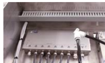
Podstawowymi elementami nowej wagi dynamicznej Teltek dla przemysłu rybnego jest sześć cyfrowych przetworników wagi PW15AHi firmy HBM
