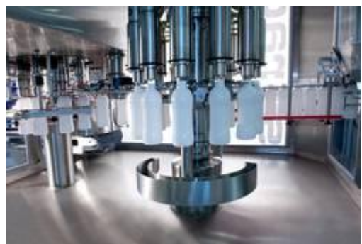
PW27 higieniczny przetwornik wagi jest używany w nowej, ultra czystej maszynie rozlewniczej dla chłodzonych, ciekłych produktów spożywczych wykonanej przez Serac.
