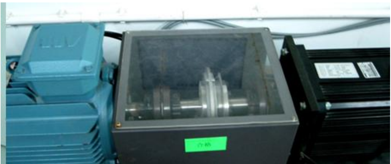
T10F- przetwornik momentu obrotowego firmy HBM zainstalowany w obiekcie testowym.
